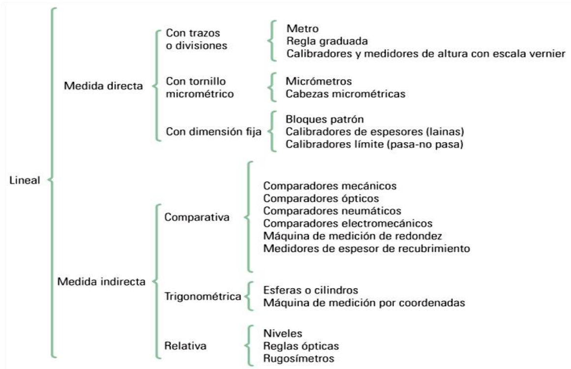
Figura 2: Clasificación de instrumentos de medición dimensional.
