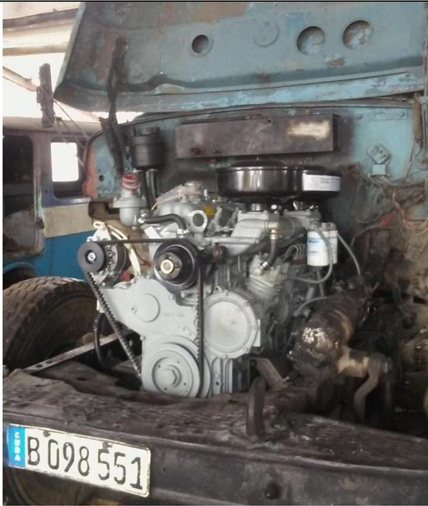
**Fig. 3 Otra vista del motor Yuchai YC6108Q instalado**
