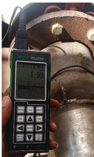
Figura 3.1 Medidor ultrasónico de espesores.
