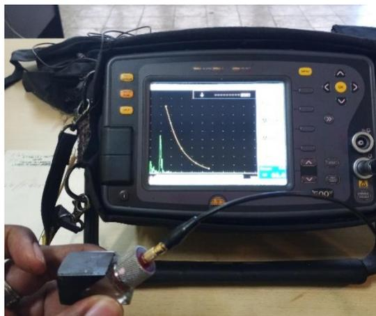
Figura 3.3 Ejemplo de una inspección ultrasónica de soldadura.
