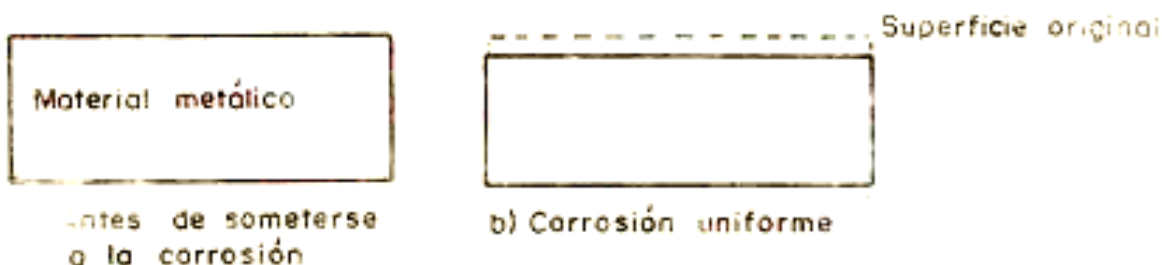
Figura 2.2 Esquema simplificado de la corrosión uniforme. Fuente (Pérez, 2011)
