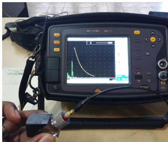
Figura 3.4 Equipo de ultrasonido para la inspección de soldaduras.
