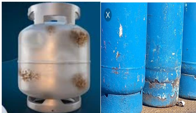
Figura 7 Cilindros de GLP dañados por corrosión, abolladuras. Fuente (Teja, 2017)
