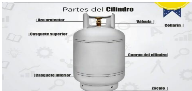
Figura 5 Estructura de los cilindros de GLP de uso domésticos. Fuente (INDOCAL, 2019)
