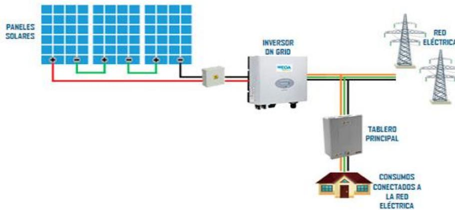
Figura 1.9 Ejemplo de una instalación conectada a la red. Fuente: (Quintero, 2021)
