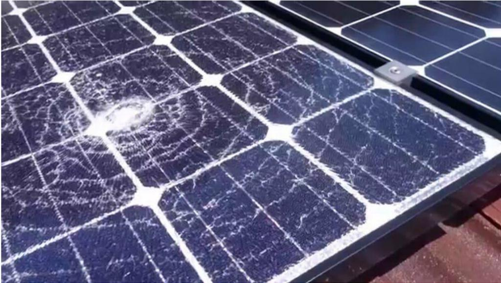
Figura 1.5 Ejemplo de panel con vidrio roto. Fuente: (Solarpedia, 2022)
