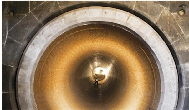
Fig. 2.14 Disposición del refractario en el interior del tubo del horno.
