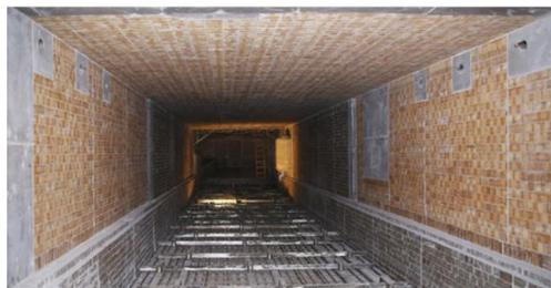
Fig. 2.20 Distribución del refractario en el interior del enfriador de clinker.
