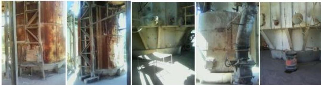
Puntos 3, 4, 5, 6 y 7: Estos puntos se encuentran ubicados en los ciclones del precalentador. Aquí se mide la temperatura de las paredes de cada etapa en el precalentador, datos que nos sirve para calcular las pérdidas de calor a través Del pre-calentador; para medir con más
