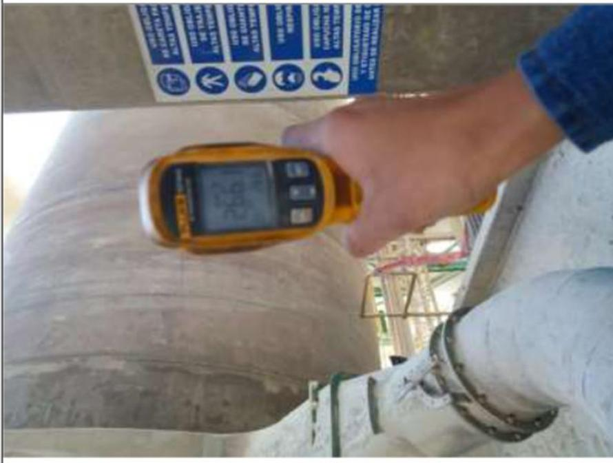
**Fotografía 5:** Toma de temperatura del horno rotatorio.
