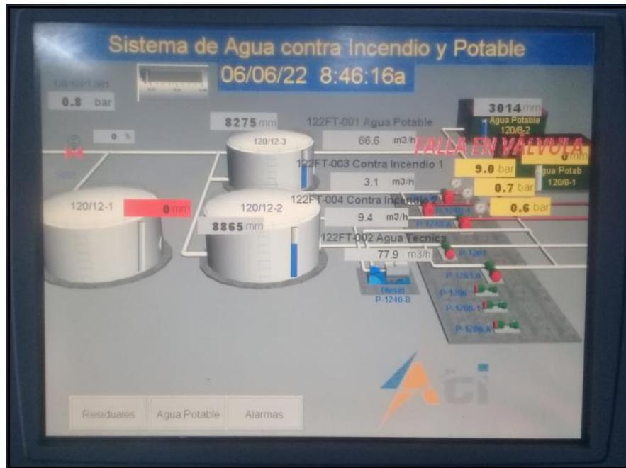
**Figura 3.1 Monitor para la visualización de los parámetros del sistema (Elaboración propia).**
