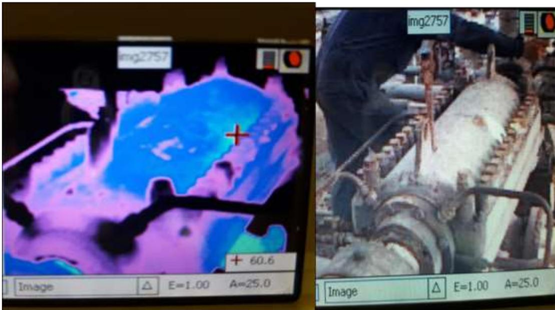
Figura 2.7 Imágenes termografías tomadas en la carcasa de la bomba en condiciones de operación actual bajo estrangulamiento.
