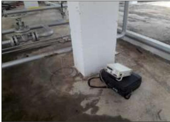
Figura 3.6 Medición de flujo por los ramales I y II en condiciones reales de operación bajo estrangulamiento.
