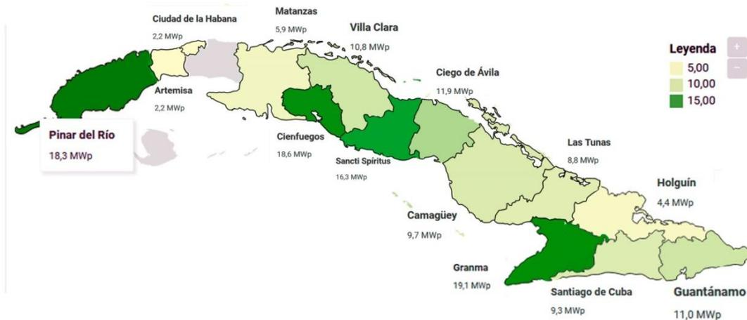
**Figura 1.6:** Potencia fotovoltaica instalada por provincias en MW. Nota: (Yilén, 2019).
