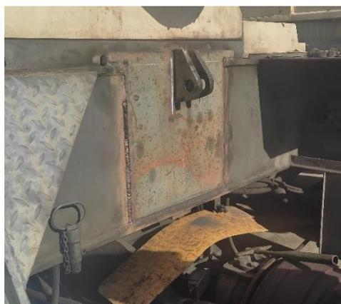
Anexo 5. Placa base y placas de sujeción soldadas. Fuente. (Proyecto Refinería de Petróleo)
