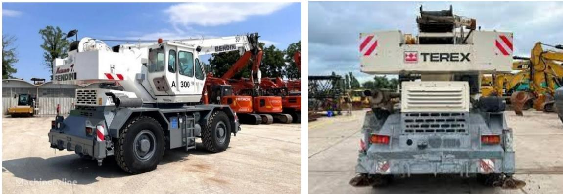
Figura 1.9 Grúa todoterreno Terex A300 de 30T. Fuente. (Crane Market, 2022)
