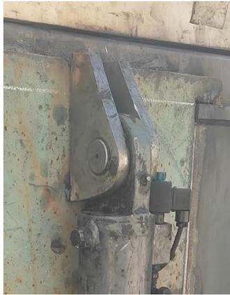
Figura 2.8 Placas soporte del pasador sobre la base de sujeción. Fuente. Proyecto Refinería de Petróleo.
