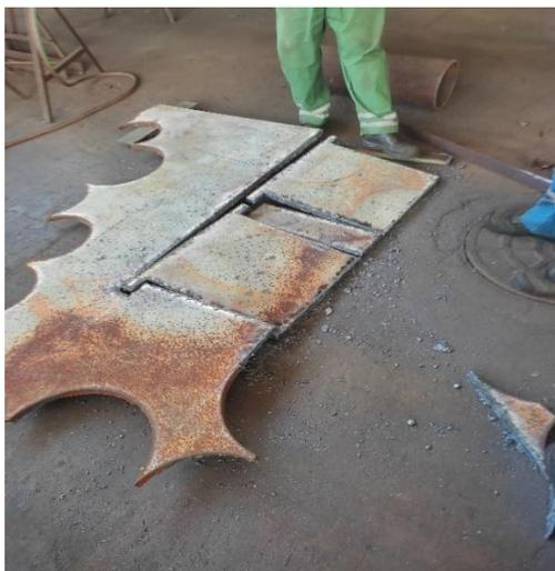
Anexo 1. Proceso de corte del metal para la fabricación de los elementos. Fuente. (Proyecto Refinería de Petróleo)
