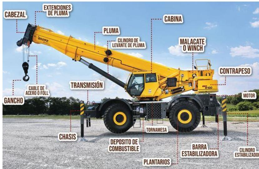
Figura 1.8 Partes de una grúa telescópica autopropulsada. (Cranes and Machines, 2022)
