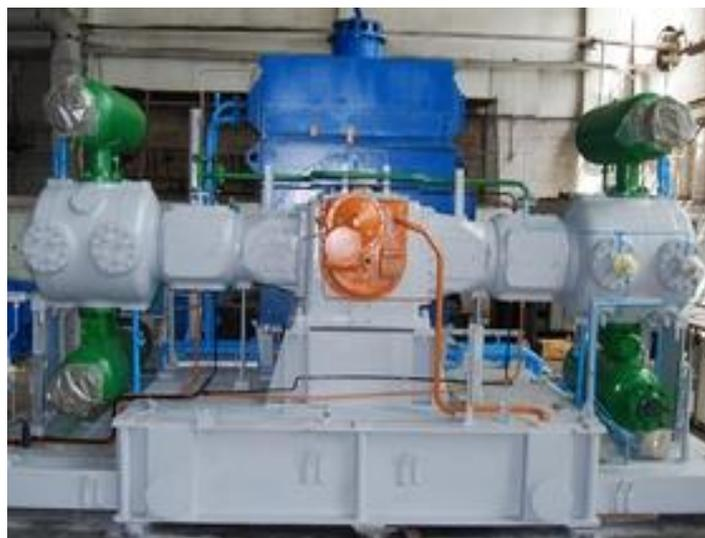
Anexo 1.3. Compresor de Hidrógeno modelo 4GM16-56/15-30
