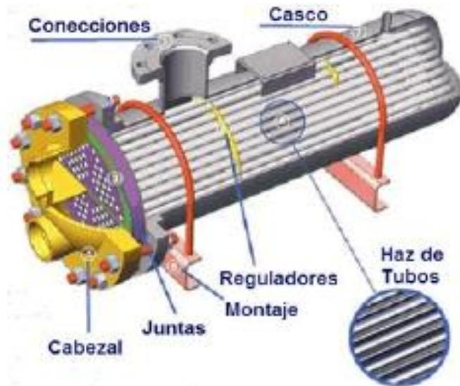
Anexo 1.11. Un ejemplo de Intercambiadores de calor de carcasa y tubos.
