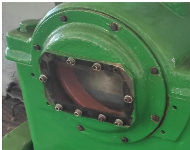
Figura 2.2 Visor para observar el proceso de lubricación.
