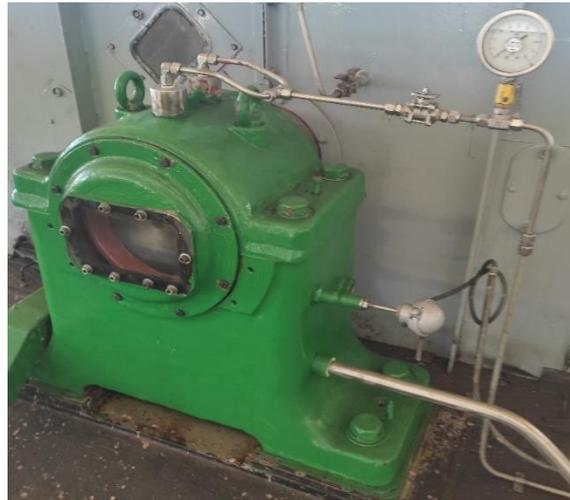
Figura 2.2. Entrada y salida de aceite del cárter (cuerpo de chumacera) para lubricación.
