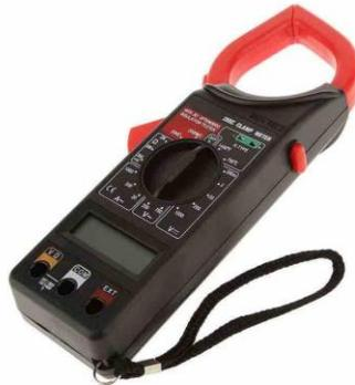
(Figura 10: Amperímetro digital)
