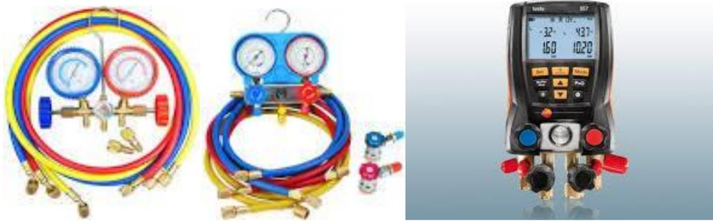
(Figura 11: Manómetros de refrigeración)
