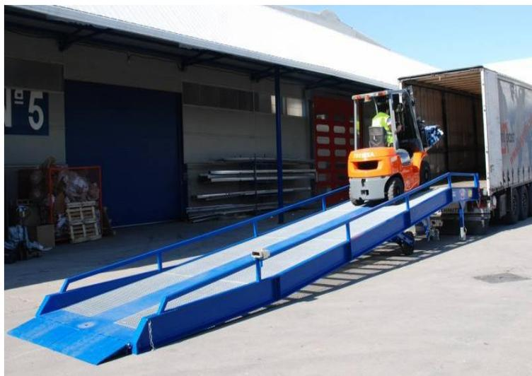
**Figura 1.8** Protecciones laterales de una rampa de 12 metros
