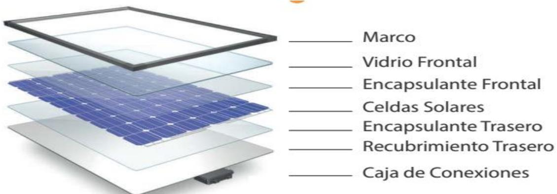
**Figura 1.11:** Partes componentes de un Panel Fotovoltaico. **Fuente:** (Tsoutso, 2011)
