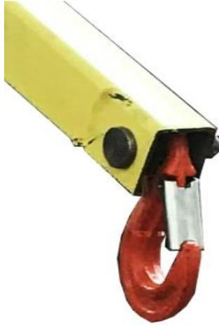
Figura 33: Gancho de carga de 1,5 ton. Fuente: Elaboración propia.
