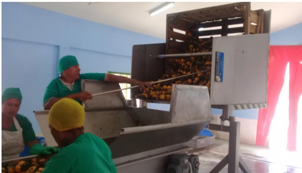
Figura 1.3 Uso de una máquina volteadora de cajas en la empresa Ceballos.
