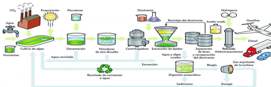
Figura 2.1 - Proceso de Transformación de las Microalgas en Biocombustibles. (Chiralde, 2018)
