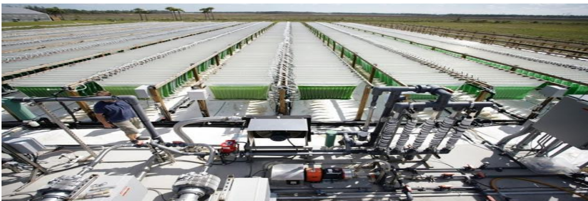
Figura 1.10 - Instalaciones de Algenol para la producción directa de biocombustibles a partir de algas (extraída de la página web de Algenol)
