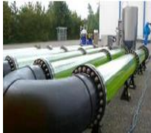
Figura 1.12 Sistemas de producción de microalgas. a) sistema abierto tipo “circuito” tipo de sistema con paletas giratorias para la circulación del agua. b) Fotobiorreactor tubular. (Torres & Machuca, 2014)
