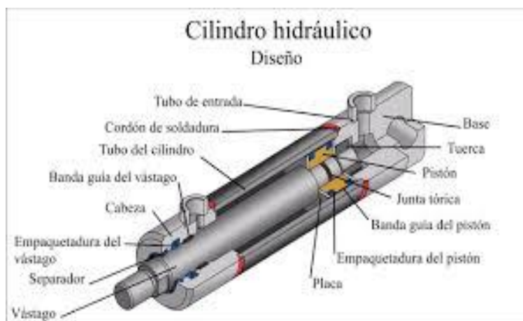
Fig. 1.14 Cilindro hidráulico. Fuente: http://www.google.com/images/search_cilindro_hidraulico .
