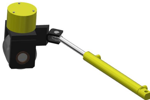
Fig. 3.8 Sistema de dirección de la Maquina. Fuente: Elaboración propia.
