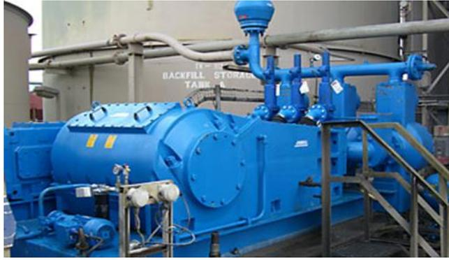
Figura 1.11: Rango de operación: hasta 600 m<sup>3</sup>/h (2640 GPM) y 25,0 MPa (3625 psi). Fuente: (Pérez, 2012).
