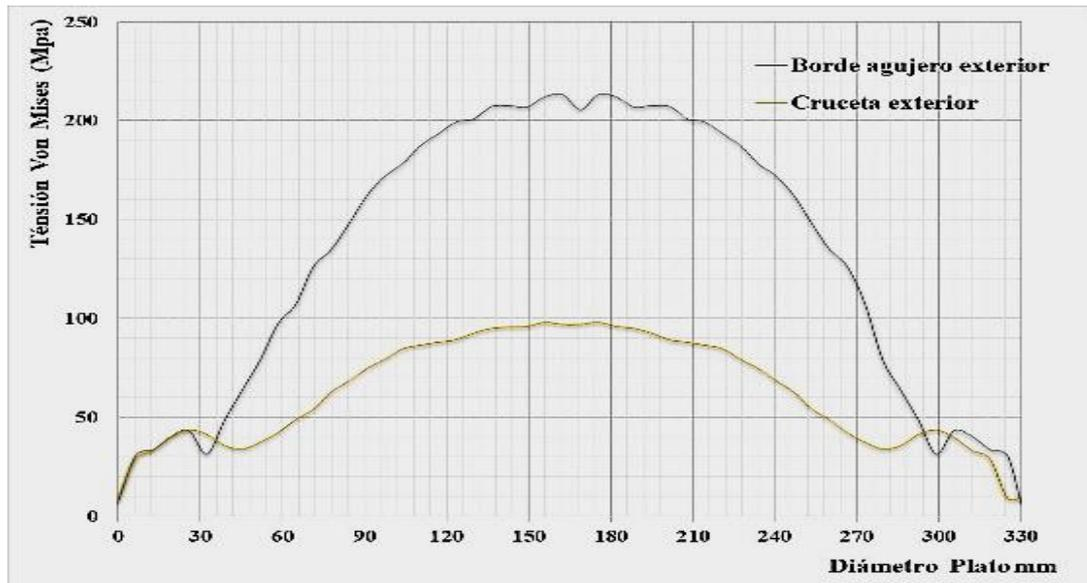
Figura 3.10: Valores de tensiones en la parte exterior del plato, convexidad.
