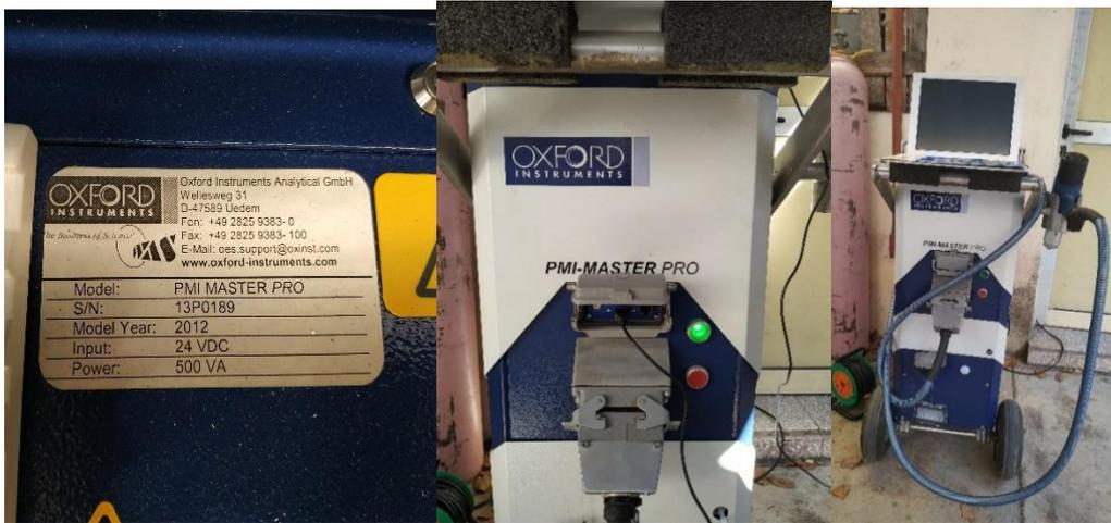
Figura 3.1: Espectrómetro de emisión óptica portátil PMI Master PRO. Fuente: Central Termoeléctrica “Carlos Manuel de Céspedes”.
