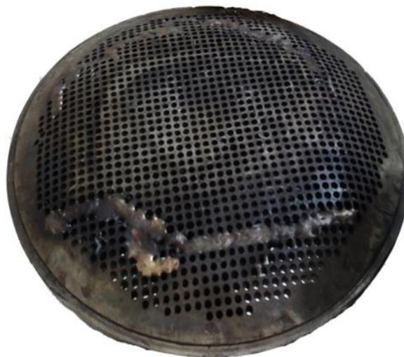
Figura 1.15: Plato perforado Bomba Master MP 2C120 y posición de las grietas y los cordones de soldadura durante su reparación. Fuente: (Borges, 2014).
