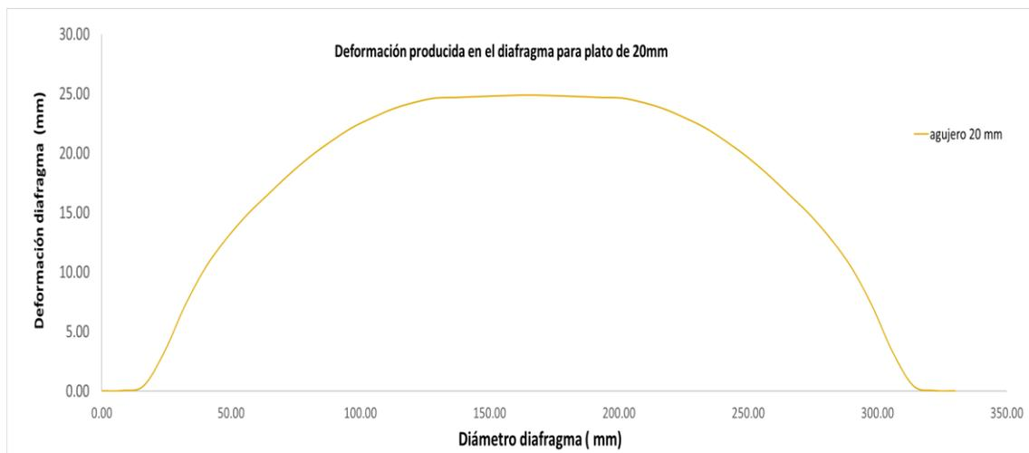
Figura 2.9: Gráfica que representa los valores de deformaciones del diafragma obtenidos en la simulación en conjunto con el plato de agujero único de 20mm. Fuente: Elaboración propia.
