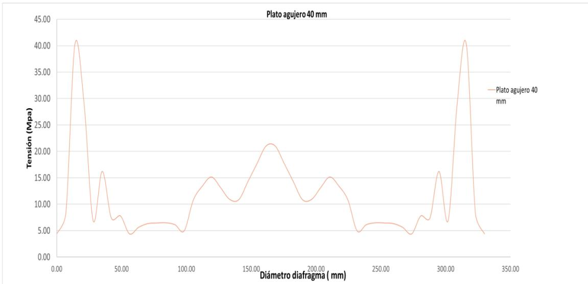
Figura 2.12: Gráfica que representa los valores de tensiones obtenidos en el diafragma en la simulación realizada en conjunto con el plato correspondiente de 40mm. Fuente: Elaboración propia.
