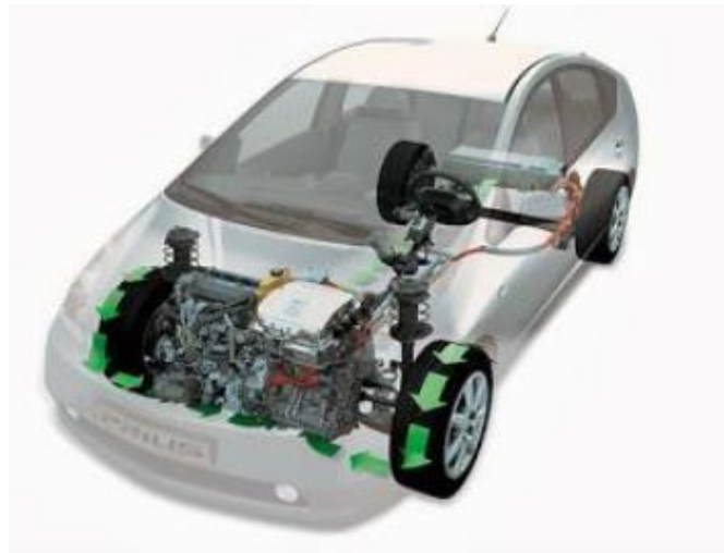
Figura 29 Esquema de frenado regenerativo (Villodres, 2015).
