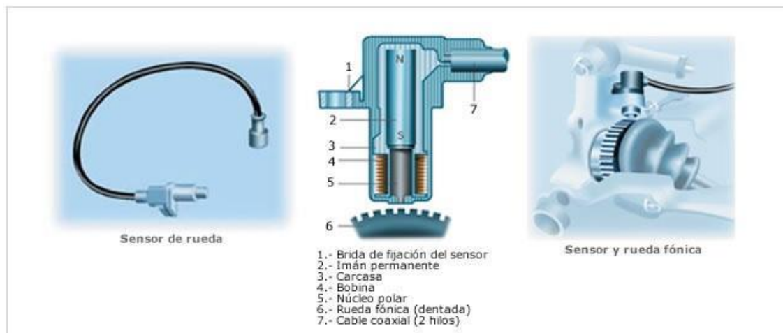
Figura 22 Esquema sensor inductivo.
