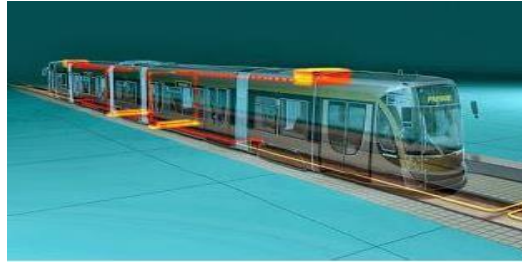
Figura 30 Freno regenerativo de un tren (Villodres, 2015).
