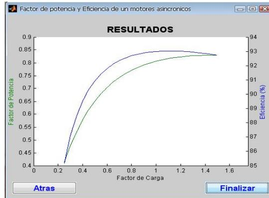
**Figura 2.3** Curva característica del motor eléctrico asincrónico del molino 1.
