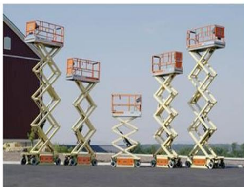
Figura 1.3 PEMP de tijera autopropulsada. Fuente: (Maldonado., 2015)
