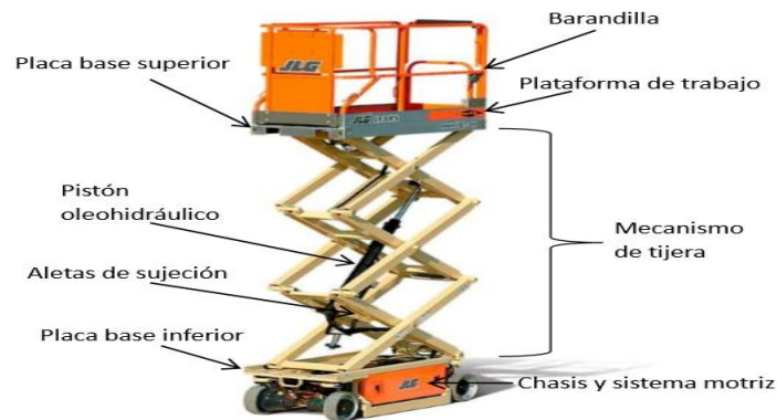
Figura 1.6 Partes generales PEMP de tijera, modelo 6RS JLG.Fuente: (Maldonado., 2015)
