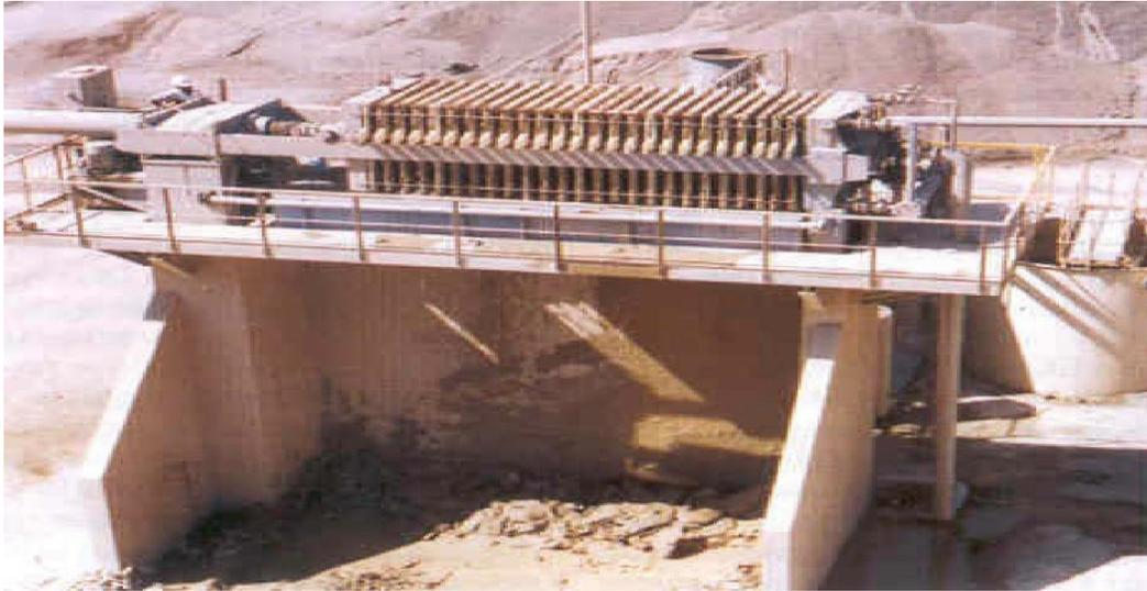
**Figura 3.4.**Filtro prensa tipo C-1500 con 28 cámaras.
