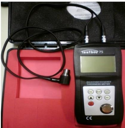
**Figura 3.5 - Medidor de espesores Ultrasónico Testboy 75. Fuente: CTE “Carlos Manuel de Céspedes”.**
