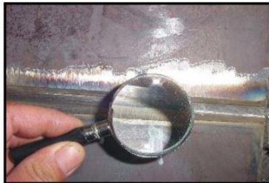
**Figura 1.2. Inspección visual a un cordón de soldadura. Fuente: CTE “Carlos Manuel de Céspedes”.**
