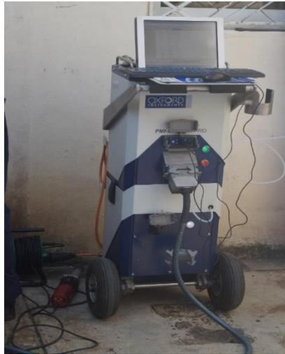
**Figura 3.3 - Espectrómetro de emisión óptica portátil PMI Master PRO. Fuente: CTE “Carlos Manuel de Céspedes”.**
