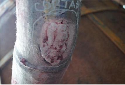
**Figura 3.8 - Aplicación de la inspección por líquidos penetrantes a la sección de un tubo del Sobrecalentador Secundario. Fuente: CTE “Carlos Manuel de Céspedes”.**
