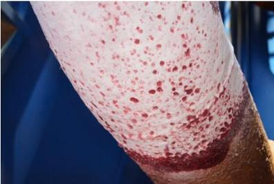
**Figura 3.9 - Aplicación de la inspección por líquidos penetrantes a una sección de un tubo del Sobrecalentador Secundario. Fuente: CTE “Carlos Manuel de Céspedes”.**
