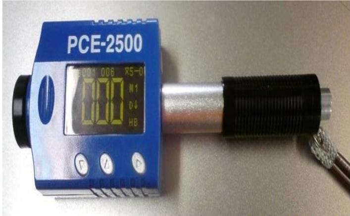
**Figura 3.6 - Medidor de dureza PCE-2500. Fuente: CTE “Carlos Manuel de Céspedes”.**
