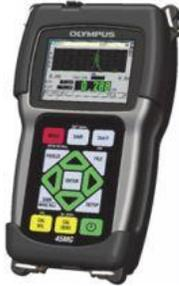
**Figura 3.4 - Medidor de espesores por ultrasonidos portátil 45MG de Olympus. Fuente: CTE “Carlos Manuel de Céspedes”.**
