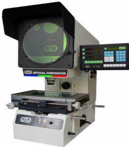
Figura 1.2: Proyector de Perfil. Fuente: (“Proyector de perfiles,” 2008)
