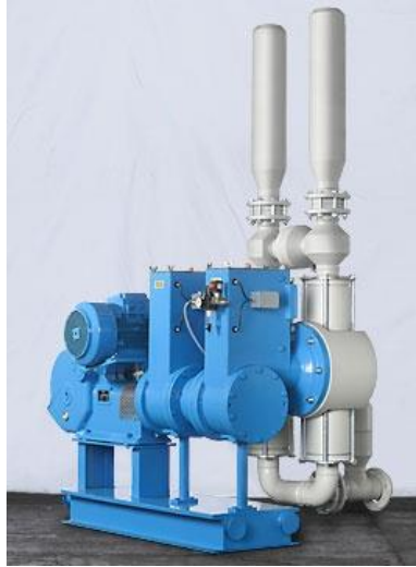
Figura 1.8: Rango de operación: hasta 100 m 3 /h (450 GPM) y 10,0 MPa (1450 psi). Fuente: (Pérez, 2012)
