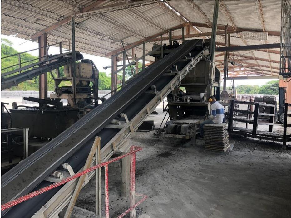
Figura 1.11: Transportador de banda o cinta transportadora dentro de la UEB. Fuente (Elaboración propia)
