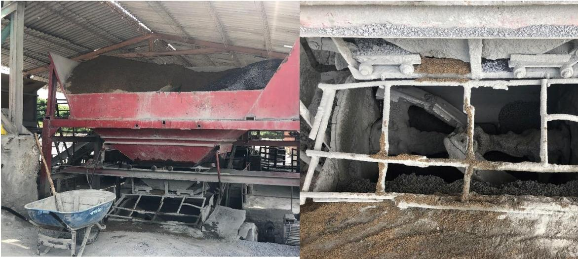
Figura 1.9 a) Dosificadora de la mezcla. Figura 1.9 b) Mezcladora. Fuente (Elaboración propia)
