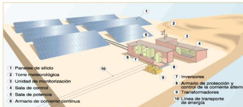
Figura: 1.3.2 Esquema básico de una central FV (ARBOLEDA & MADRIGAL, 2009)
