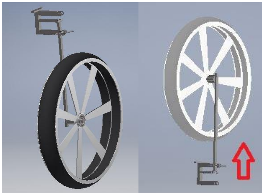
Figura 2.18 Mecanismo para separar las ruedas del suelo. Fuente: Elaboración Propia.
