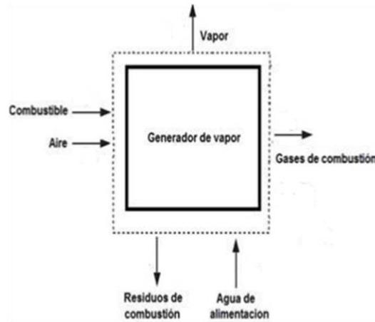
Figura II.4 Corrientes de entrada y salida en un generador de vapor. Fuente:(Elaboración propia)
