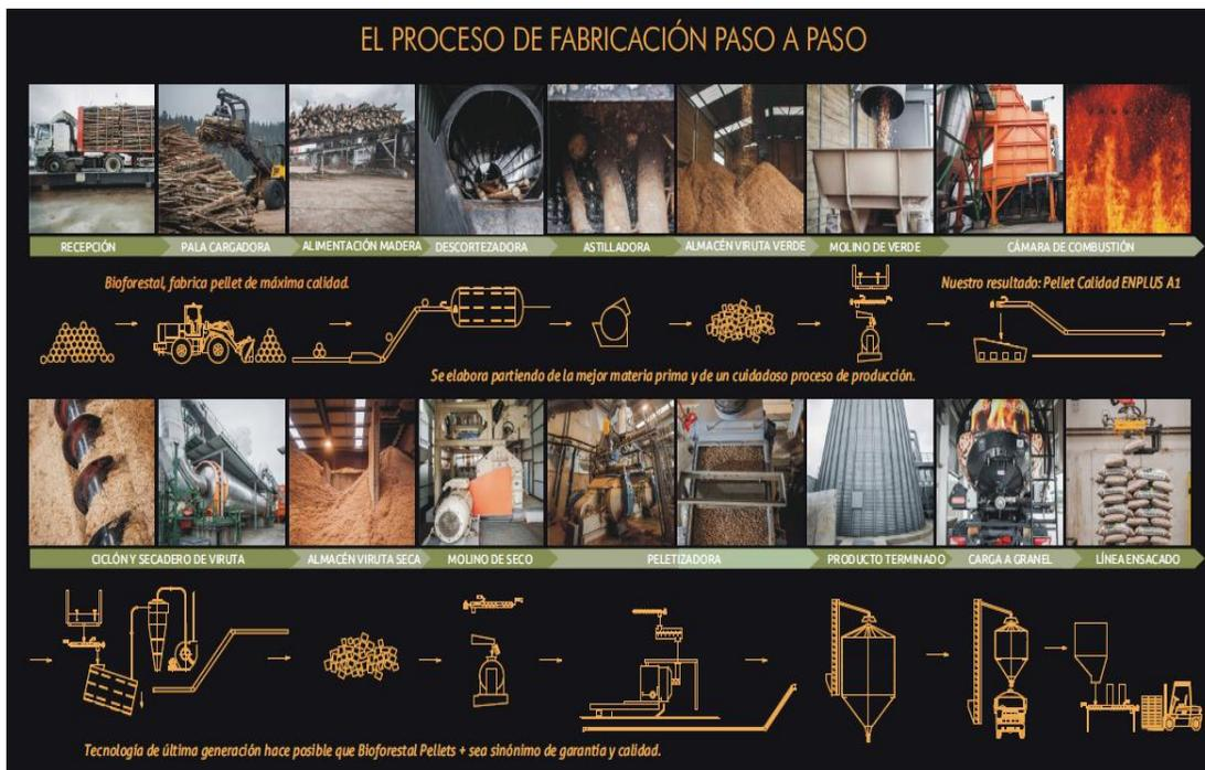
Fig. I.8: Proceso de fabricación del pellet. (Fuente: <http://www.biofores.es>)
