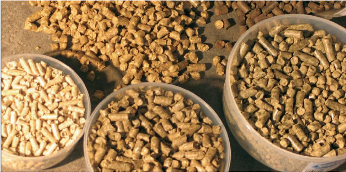
Fig. I.7: Biomasa forestal troceada y pelletizada. (Fuente: <http://www.epec.com.ar>)
