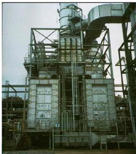
**Figura 1.3:** Horno tipo cabina. **Fuente:** (Palacio Toledo, C. I. 2011).
