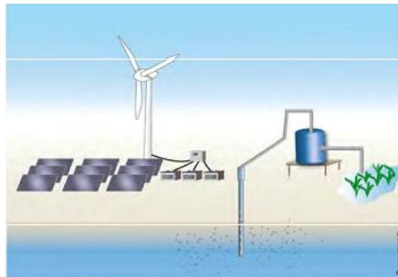
**Figura 1.17 Energía fotovoltaica y eólica se complementan muy bien suministrando electricidad para una bomba de agua y un sistema de irrigación. Fuente: (CNCI, 2016)**
