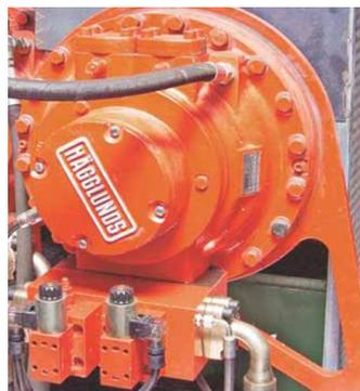
**Figura 1.5 Foto de un motor hidráulico de pistones radiales como los utilizados en el accionamiento de los molinos. (Tomado de [www.hagglunds.com](http://www.hagglunds.com))**
