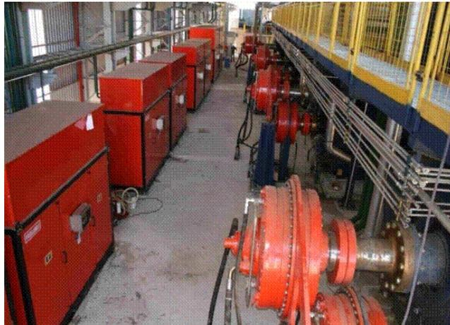
**Figura 1.6 Foto de un tren de molinos accionado por motores hidráulicos.**
