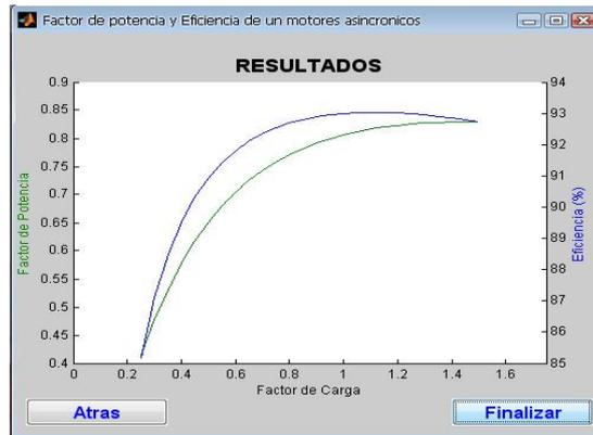
**Figura 3.2** Curva característica del motor eléctrico asincrónico del molino 1
