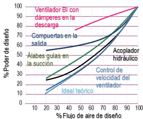
**Figura 1.6** Curvas de los diferentes métodos de control de caudal sobre el consumo de potencia del ventilador. Fuente: (Yanes, 2016)
