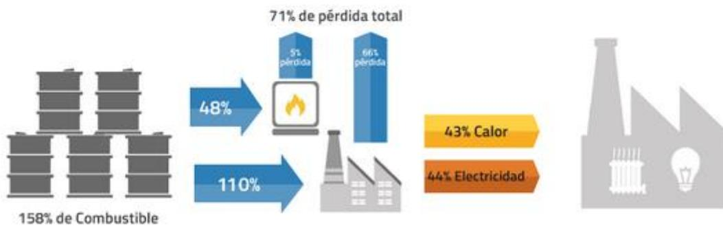
Figura I.3: Planta convencional de electricidad y caldera y planta de cogeneración (fuente:www.fenercom.com)
