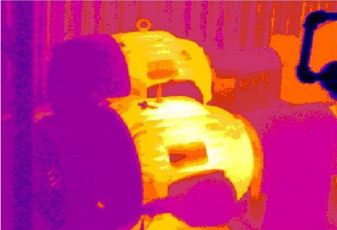
Anexo(C) Imagen térmica de un motor eléctrico operando
