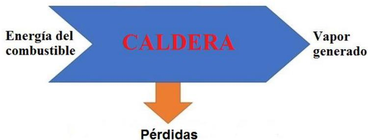
Figura I.7 Balance de energía en una caldera. Fuente: Arrollo 2016.
