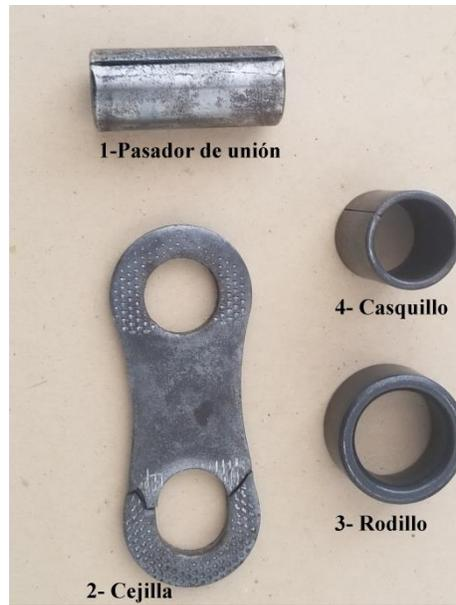
**Figura 3.5 Elementos de la cadena 160 Fuente: imagen real de cadena**
