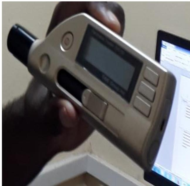
**Figura 3.3 Durómetro portátil, Fuente: laboratorio de resistencia de la Universidad de Cienfuegos.**
