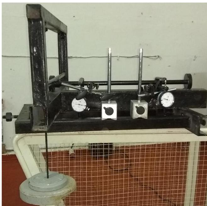
**Anexo III: Maqueta para determinar los desplazamientos en barras quebradas.**
