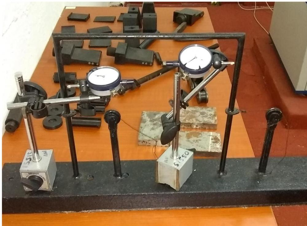
**Anexo V: Maqueta para Flexión longitudinal en Ensayos de columnas metálicas.**
