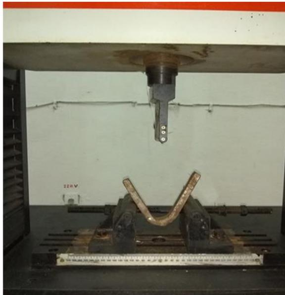
**Fig.2.3.4 Modo de fijación de carga en las vigas.**
