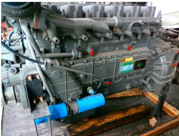
**Fig. 4 Motor Weichai 615.44 con la caja de velocidad del camión IVECO**
