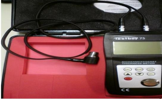
❖ El medidor de espesores Ultrasónico Testboy 75, es un instrumento manual para hacer mediciones rápidas y precisas de distintos espesores de materiales, es capaz de medir los espesores de varios materiales con una alta precisión en el rango de  $\pm 0.5$  mm ( $\pm 0.1$ ). Entre los materiales que pueden ser medidos se encuentran: Acero, Cobre, Aluminio, PVC, Polietileno, entre otros.
