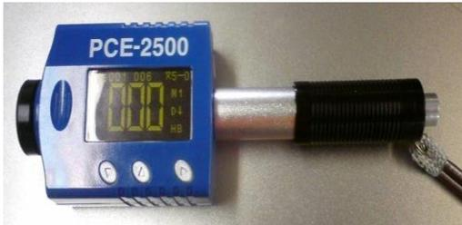
El medidor de dureza PCE-2500, es un avanzado mini medidor de dureza que se caracteriza por su alta precisión, gran rango de medición y su facilidad de uso. Es adecuado para medir la dureza de metales y puede ser usado en infinidad de sectores industriales
