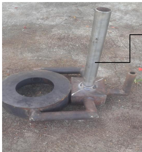
Fig. 4.5 hornilla para la olla, con colectores de gases de la combustión y chimeneas.
