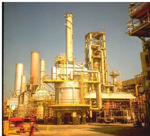
Figura 1.2: Horno cilíndrico vertical. Fuente: (Palacio Toledo, C. I. 2011).
