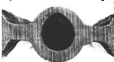
Figura 1.6 Sección transversal de un tubo expuesto a sobrecalentamiento por corto tiempo. El lado de la superficie superior del tubo se ha adelgazado y ovalado como resultado a de la exposición a temperaturas excesivamente altas.
