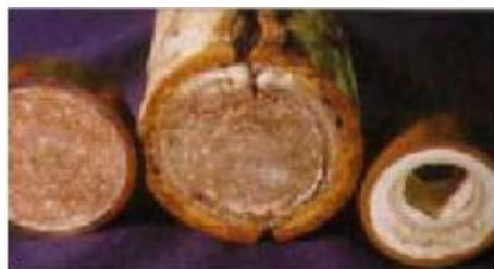
Figura 1.8 Depósito en el interior de los tubos de calderas.
