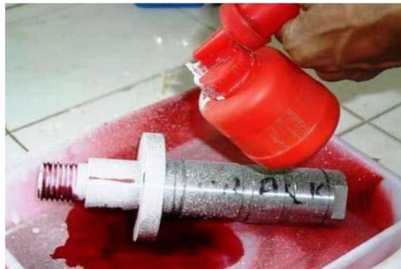
Figura 1.14. Aplicación de líquidos penetrantes para resaltar fisuras (Ponce, 2007).
