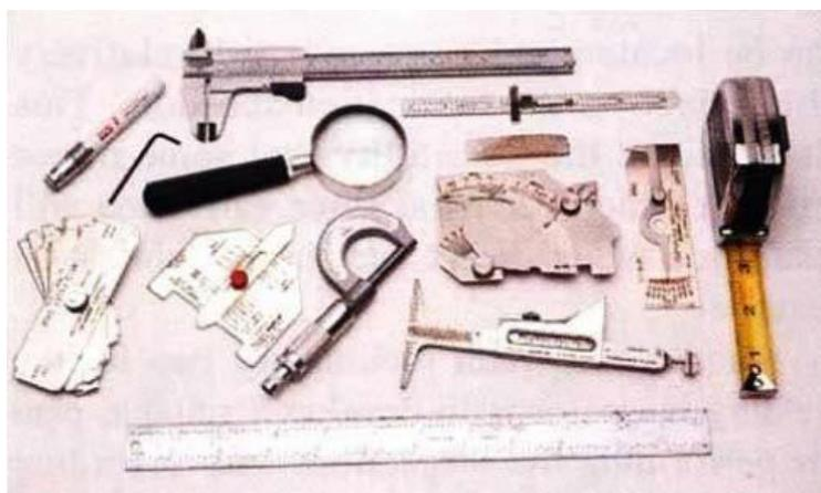
Figura 1.13. Instrumentos de medición y magnificación usados en la inspección visual (Ponce, 2007).
