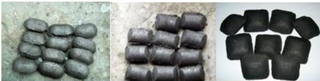
**Figura 1.2 Ejemplo de briquetas de carbón vegetal**
