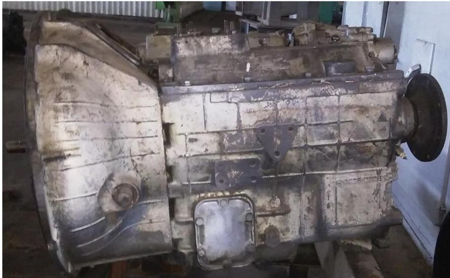
**Fig. 1.13. Caja de cambio de camión de volteo KRAZ-256B1M.**
