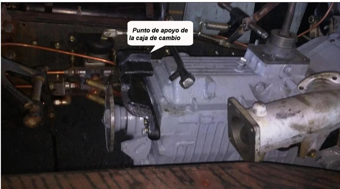
**Fig. 1.14. Punto de apoyo de la caja de velocidades del camión KRAZ-256B1M.**
