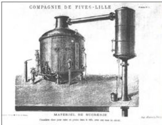
Figura 1.15 Tacho para la cocción y cristalización de la compañía Fives- Lille. (Marín, 2012)
