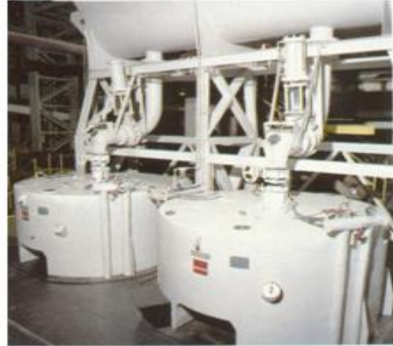
Figura 1.11 Bancos de centrifugas continuas. (Victoria, 2009)
